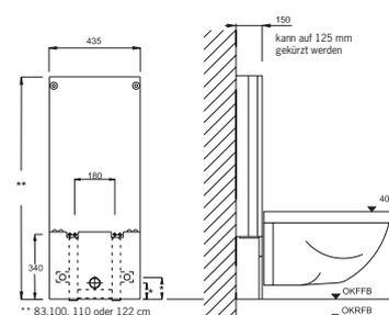
\* Die Maße für Wasseranschluss und Abfluss werden auf das bei der Bestellung angegebene Bidet vom Werk abgestimmt.
