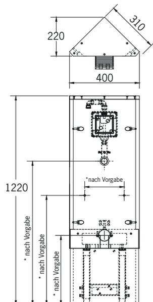
\* Die Maße für Wasseranschluss- und Abflusshöhe sowie die Befestigungsbohrungen für das Urinal-Becken werden für das bei der Bestellung anzugebende Urinal-Modell werkseitig vorgerichtet.
