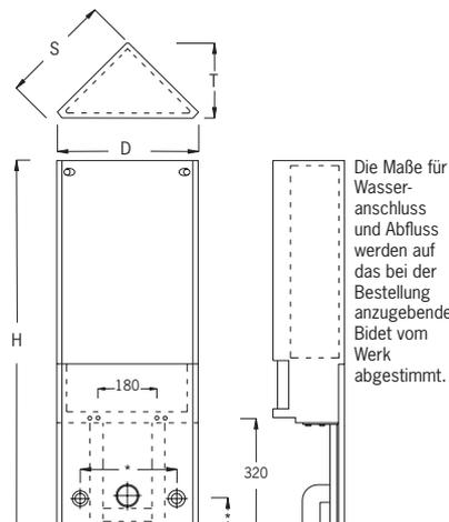
Die Maße für Wasseranschluss und Abfluss werden auf das bei der Bestellung anzugebende Bidet vom Werk abgestimmt.
