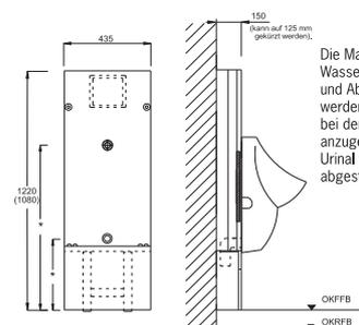
Die Maße für Wasseranschluss und Abfluss werden auf das bei der Bestellung anzugebende Urinal vom Werk abgestimmt.
